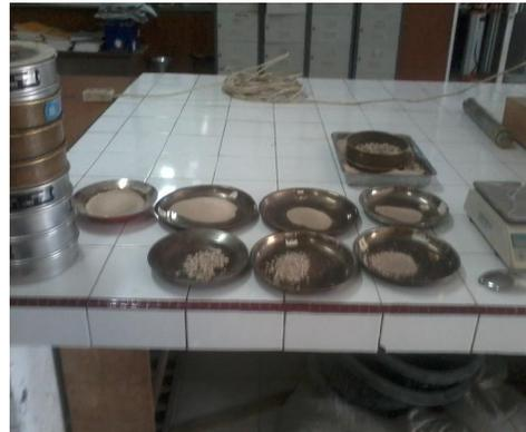
Gambar 3 Susunan gradasi agregat halus yang tertahan pada masing-masing saringan.
