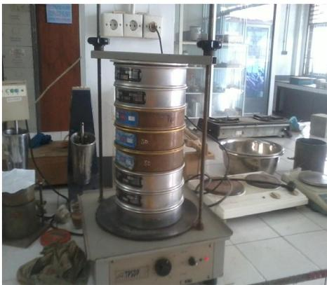
Gambar 2 Pemeriksaan gradasi agregat halus menggunakan mesin penggetar saringan (*Shieve shaker*)
